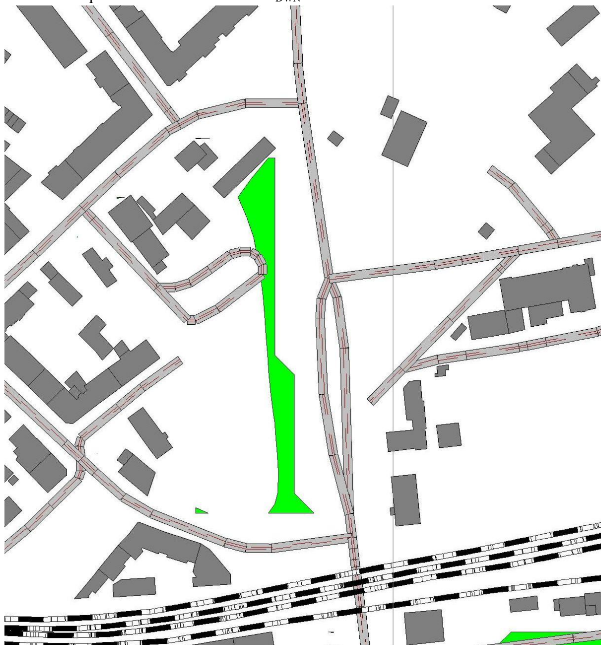
Plansza 2. Brama Głogowska (od ul. Głogowskiej do ul. Prusa) – obszary objęte przekroczeniem wskaźnika L_{DWN}
