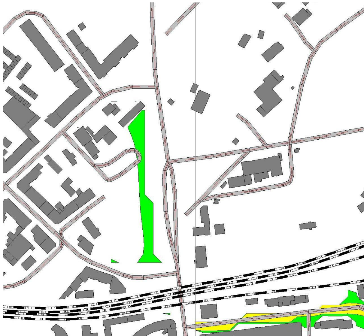
Plansza 2A. Brama Głogowska (od ul. Głogowskiej do ul. Prusa) – obszary objęte przekroczeniem wskaźnika L_N
